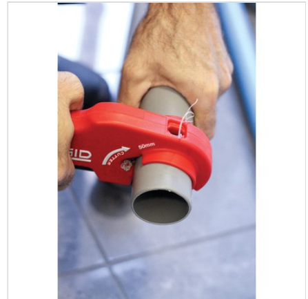
Offene Bauweise für das 50-mm-Rohr.
