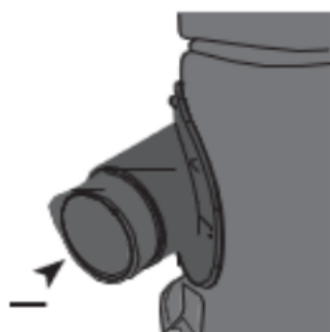
Figures 4 et 5 : dépose de la manchette et déplacement de l'adaptateur.
